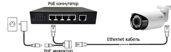
С целью безопасности необходимо обеспечить соответствующее заземление камеры. В случае однофазного заземления системы, импеданс системы должны быть менее 4 Ω, площадь заземления повода по земле должна быть более 25мм<sup>2</sup>.
