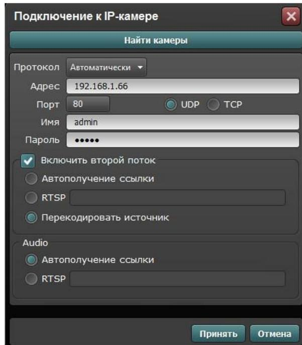
Далее нажмите на кнопку «Принять» и ожидайте некоторое время, несмотря на сообщение об отсутствии сигнала и невозможности применения настроек (до 1 минуты). Для примера на рисунке показан интерфейс ПО «Линия» с добавленной IP камерой BSP-BO13-VF-02.
